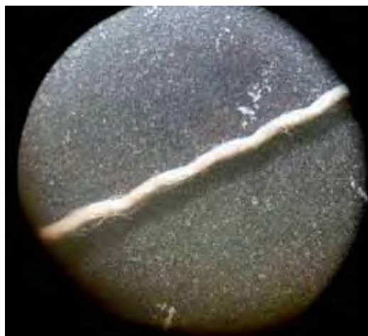
Análisis mediante microscopio de la fibra, identificada como algodón.
