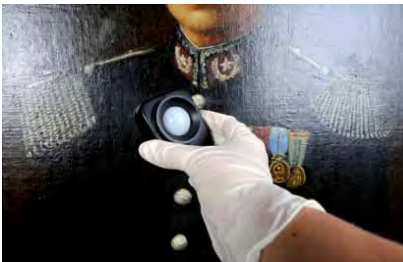
Medición de luz a través de luxómetro.
