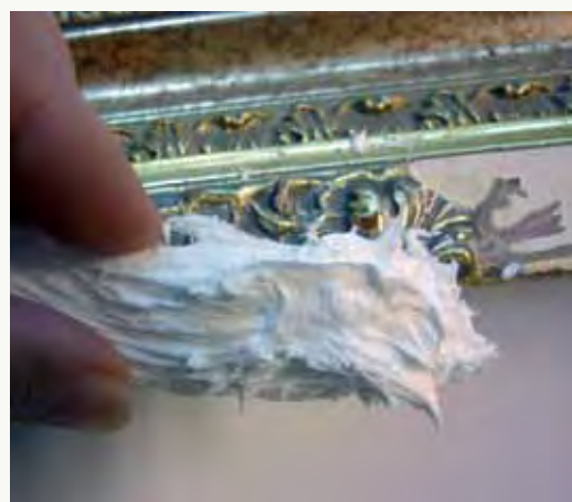
Extracción del molde de silicona.
